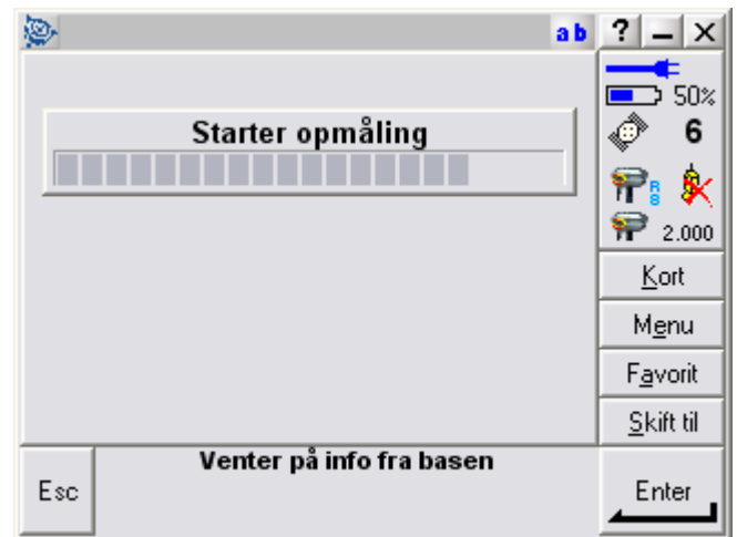
Figur 5 Rødt kryds over telefonen betyder oftest, at forbindelsen er etableret, men GPS modtageren venter på korrektioner fra GPSnet.dk
