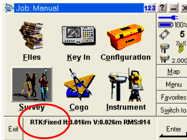
Figur 6 GPS'en skal være fixed før du måler
